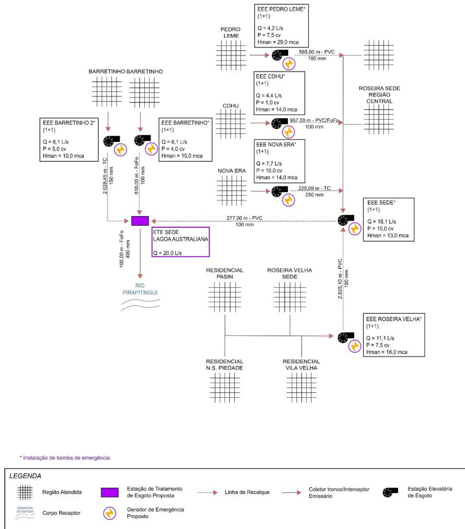
Figura 4 – Croqui das Intervenções Propostas para o Sistema de Esgotamento Sanitário Sede
