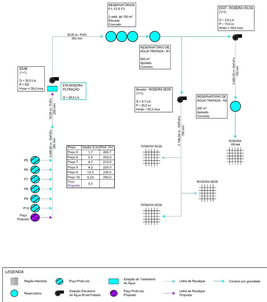
Figura 3 – Croqui das Intervenções Propostas para o Sistema de Abastecimento de Água Sede.
