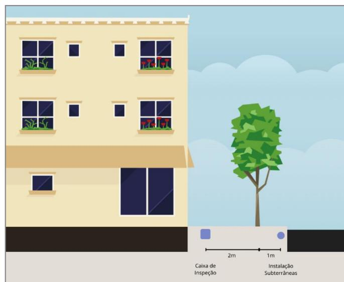
FIGURA 15 - ESPAÇAMENTO ENTRE CAIXAS DE INSPEÇÃO, INSTALAÇÕES SUBTERRÂNEAS E ÁRVORES
