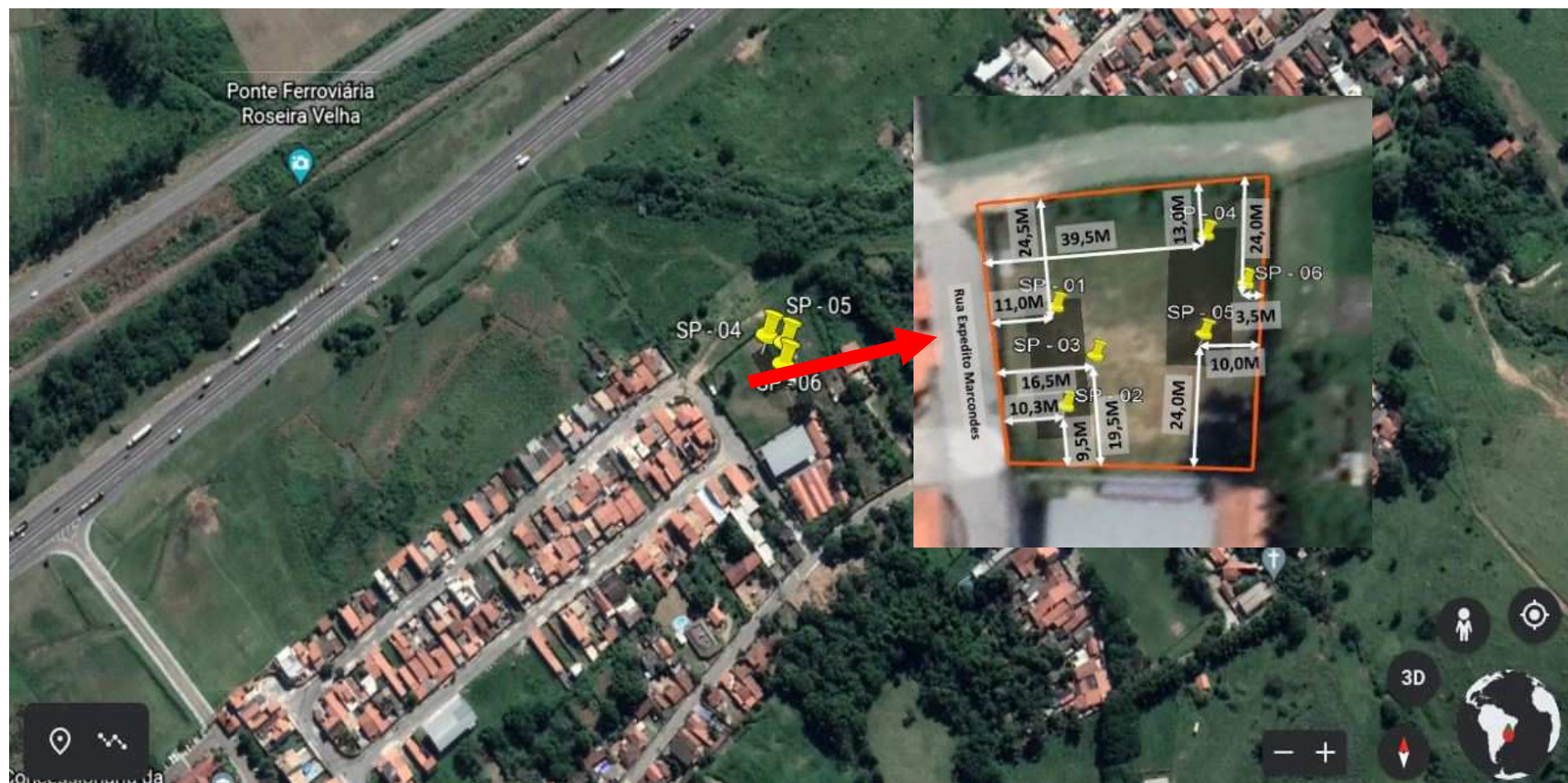
Figura 1 – Pontos de sondagem SP-01 a SP-06
